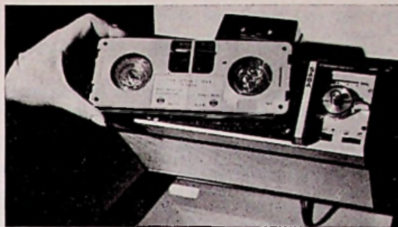
Afb. 9 - Dit is de cassette van de Sabamobil. Hij bevat twee normale 8 cm spoeltjes en wordt voorbespeeld geleverd door Saba. Was zijn tijd te ver vooruit.
